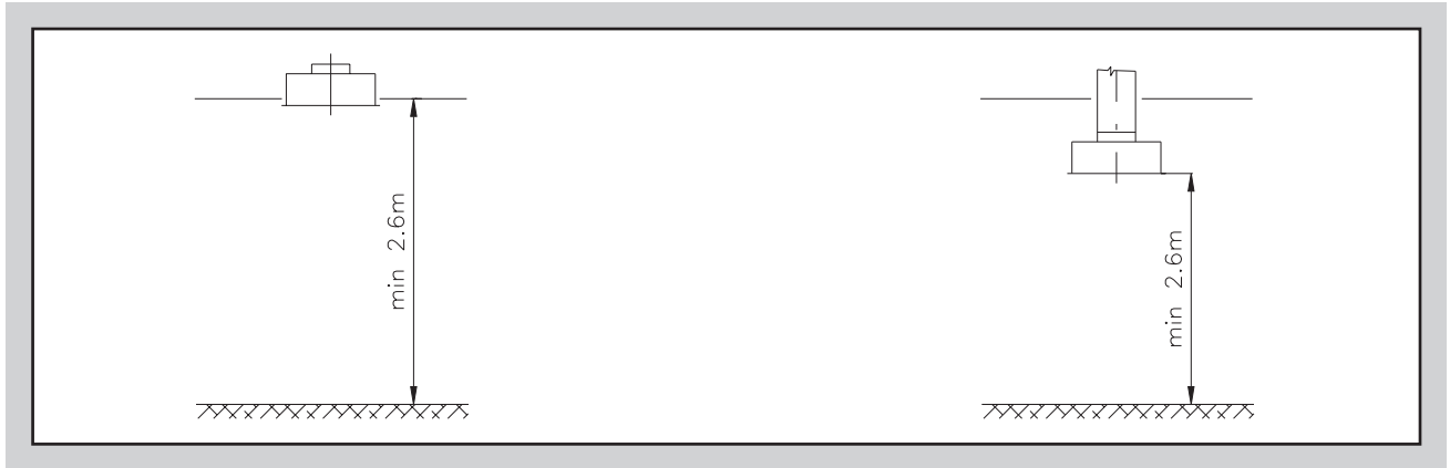
Montaż poza sufitem podwieszanym
